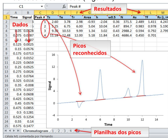
Figura 2. Visão geral de um cromatograma, após reconhecimento automático e integração dos picos.
